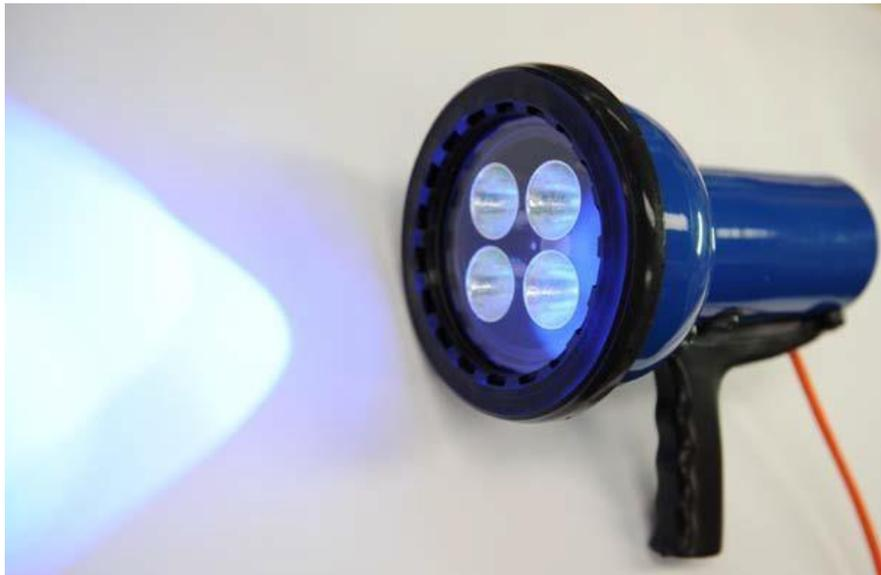
1. **Lampada UV a LED mod. "Shuttle"** – Lampada UV a LED ad alta intensità (fino a  $8.000 \mu\text{W}/\text{cm}^2$  a 38 cm di distanza), copre un'area di oltre 30 cm di diametro (minimo  $1.000 \mu\text{W}/\text{cm}^2$ ) per una maggiore produttività del controllo. **Caratteristiche:**
