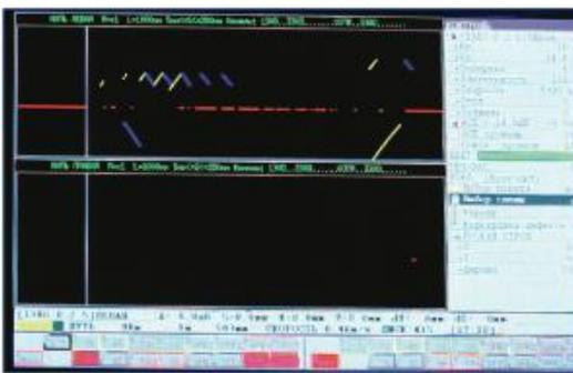
Display modalità: A-Scan + B-Scan per 1 canale
